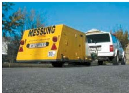
Abbildung 3: Rollgeräuschanhänger nach RVS 11.066 IV
