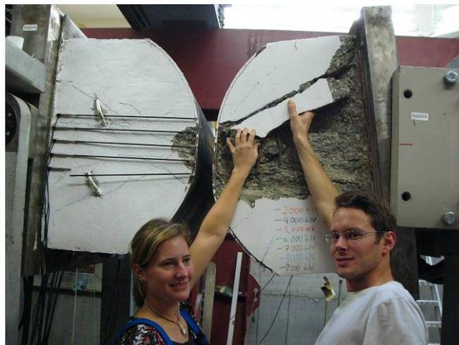
Abbildung 2: Wälzgelenke mit Radius 0.5 m, Stahlblechdicke 10 mm, nach dem Belasten bei Laststufe 10000 kN
