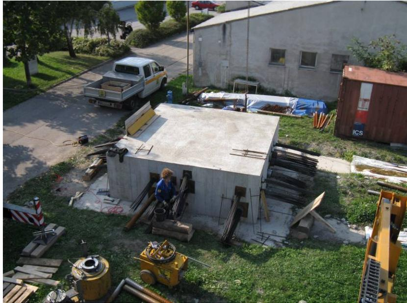
Abbildung 3: Betonblock mit umgelenkten Spanngliedern eingebaut
