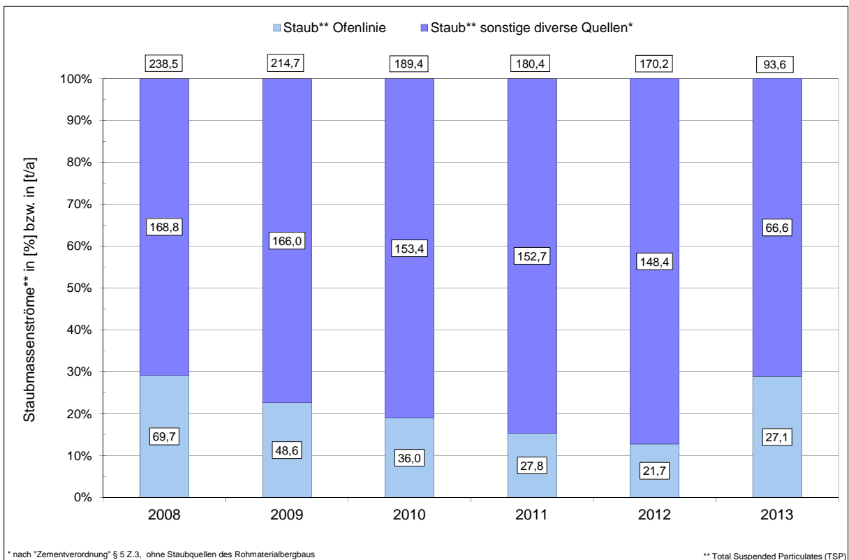
Abbildung 3-30: staubförmige Emissionen unter Berücksichtigung von Staubemissionen aus "sonstigen definierten Quellen" nach "Zementverordnung" § 5 Z.3 für Anlagen der österreichischen Zementindustrie (exklusive Mahlwerke) im Beobachtungszeitraum 2008 bis 2013
