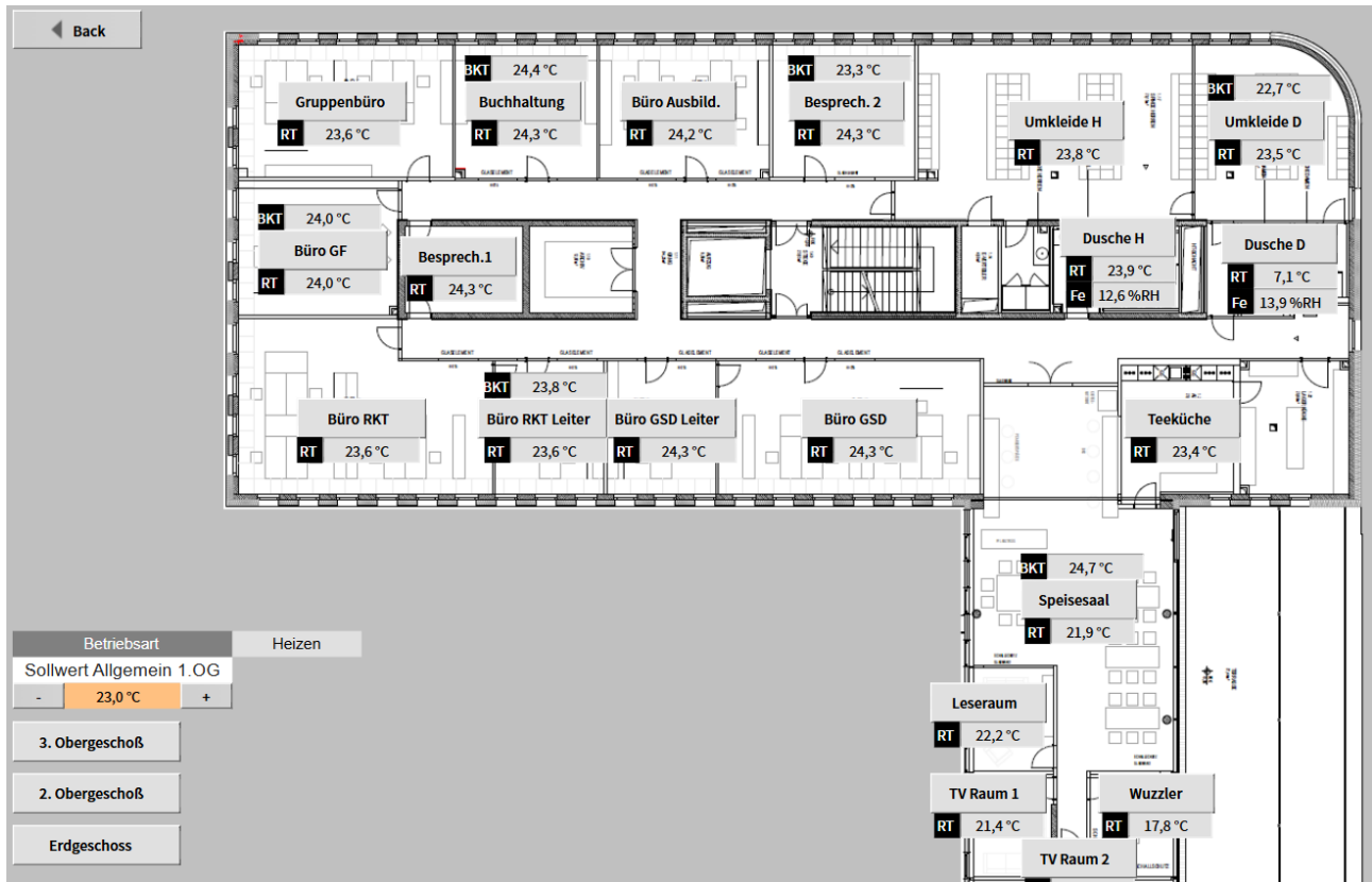
Darstellung des 1. OG mit Angabe der Temperatur in den Betonkernen und in den Räumen. Foto: Rotes Kreuz Korneuburg
