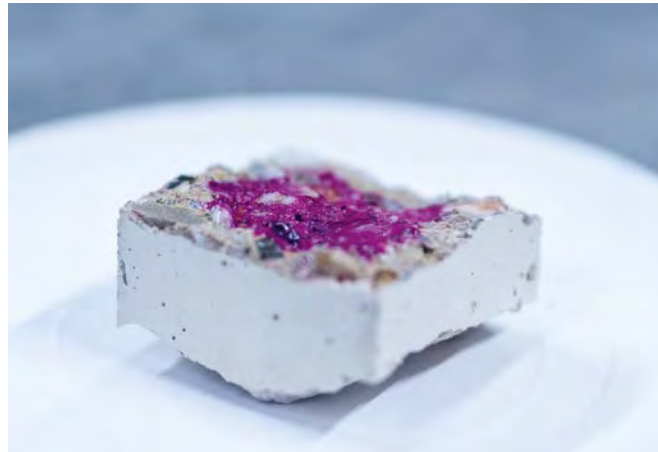
Die zur Gänze carbonatisierten Brechsandfraktionen werden als Recyclingmaterial in Bauprodukten eingesetzt und die Auswirkungen auf die Produkteigenschaften untersucht.
