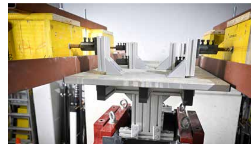
Beton wird mit dem Mobile Seismic Simulator systematisch zum Schwingen angeregt
