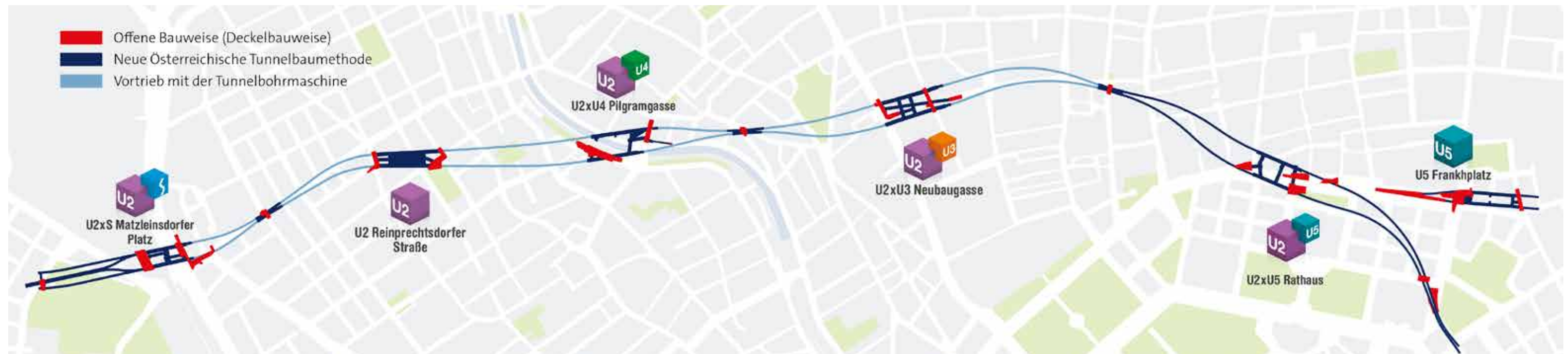
Übersicht Bauweisen Baulos U2/17 bis U2/21
