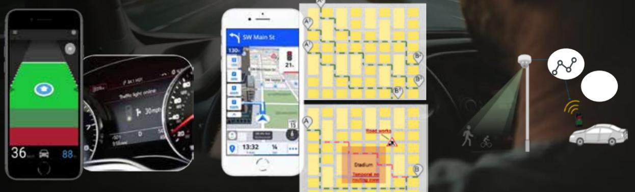
Eine App zeigt Autofahrern und Radfahrern den optimalen Geschwindigkeitsbereich an, um in einer permanenten grünen Welle fahren zu können
