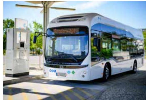
Der 11-Meter lange ELEC CITY Wasserstoff-E-Bus von Hyundai im VOR-Testbetrieb.
