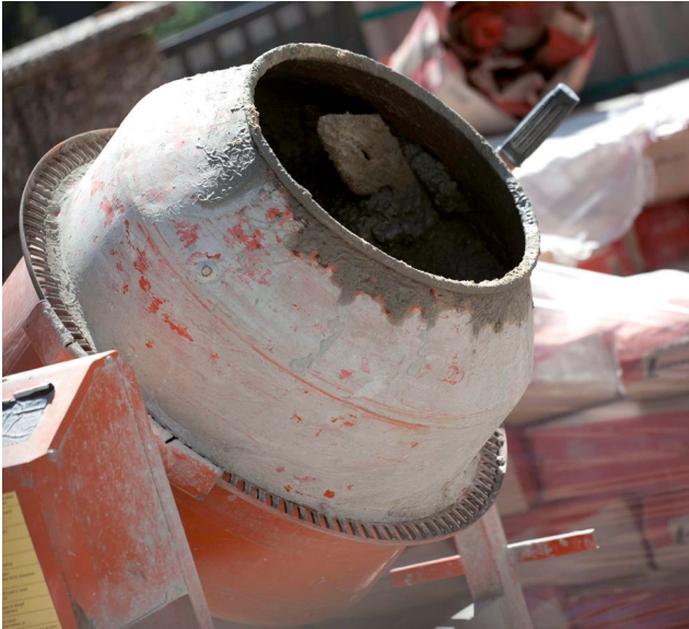
Abb. 10: Freifallmischer für kleine Betonmengen
