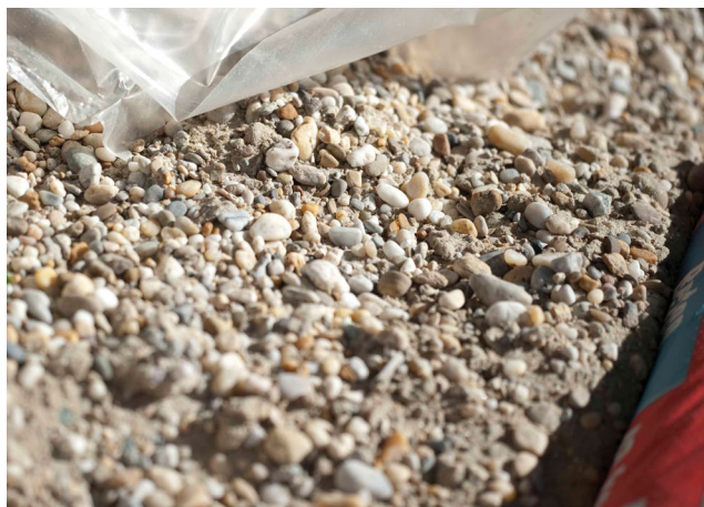
Abb. 12: Die Gesteinskörnung sollte nicht der direkten Sonneneinstrahlung ausgesetzt sein (Sonnendächer, Matten, Planen).
