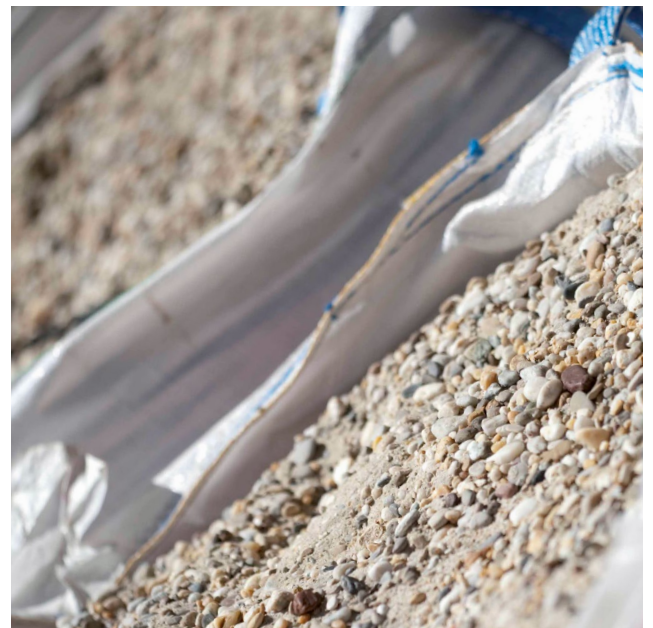
Abb. 6: Gesteinskörnung in verschiedenen Größen verwenden – bestellt wird nach Größtkorn.
