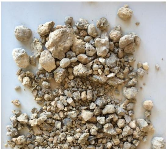
Solidia Zement™ besteht ebenso wie Portlandzement aus Calziumsilikatphasen, jedoch weniger kalkreichen als herkömmlicher Portlandzement. Da die gleichen Rohmaterialien, nur in unterschiedlichem Verhältnis, zur Herstellung von Solidia Klinker eingesetzt werden, kann dieses Produkt in vorhandenen Zementanlagen produziert werden. Solidia Technologies® und LafargeHolcim haben gemeinsam bisher zwei industrielle Großversuche mit großem Erfolg durchgeführt.
