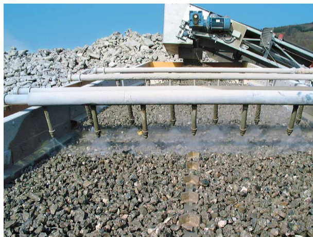
Abb. 2: Sieben und Waschen der Recyclingkörnungen
