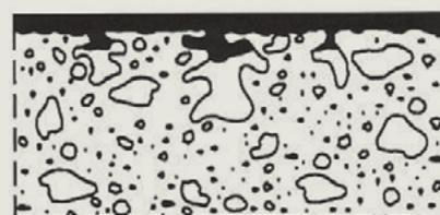
**Beschichtung:** Eine geschlossene Schutzschicht von 0,1 bis maximal 5 mm liegt auf der Betonoberfläche.
