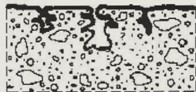
**Imprägnierung:** Die Porenwände und die Oberfläche werden von einem nicht vollständigen Film bedeckt. Bei der Versiegelung werden die Poren und Kapillaren möglichst vollständig gefüllt.
