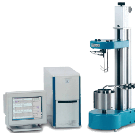
Abb. 1: der Viskomat NT der Fa. Schleibinger
