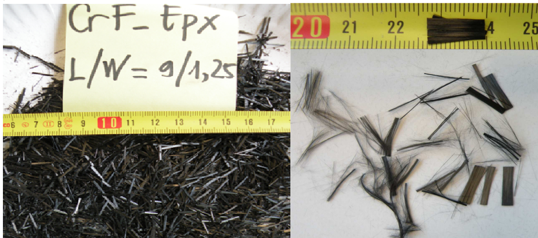
Bild 1: Faserbündel (links) im Vergleich mit den ursprünglichen Fasern (rechts)
