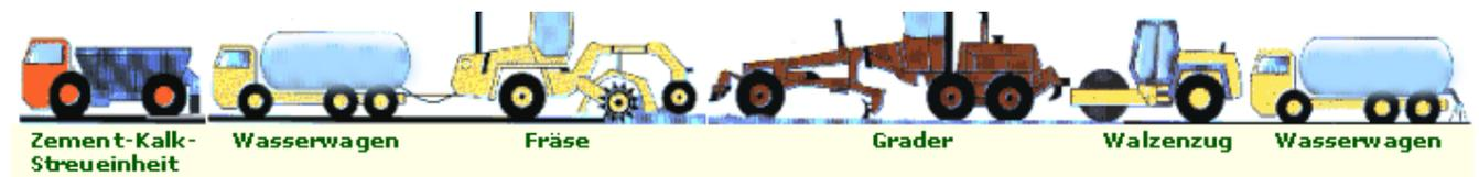
Der Einbauzug setzt sich aus der Zementstreueinheit, Wasserwagen, Fräsen, Walzenzug, Gräder und Walzenzug zusammen.
