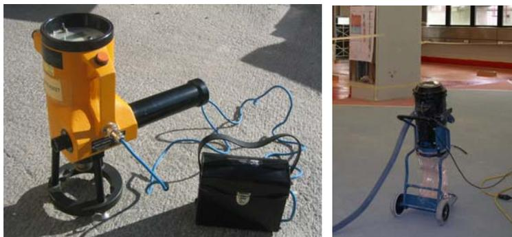
Werden Schutzschichten erneuert, also auf eine bereits vergütete Betonoberfläche aufgebracht, muss dieser Untergrund hinsichtlich Verträglichkeit beurteilt und die Haftung am Beton geprüft werden. Die Oberfläche ist unbedingt aufzurauen.
