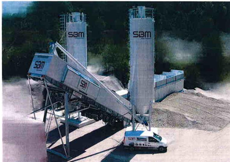
Die erste Anforderung ist die Produktion von Massenbeton mit einer Ausstoßleistung bis 200 m<sup>3</sup> pro Stunde im Contibetrieb mit einer stufenlose Leistungsverstellung von 120 bis 200 m<sup>3</sup>.
