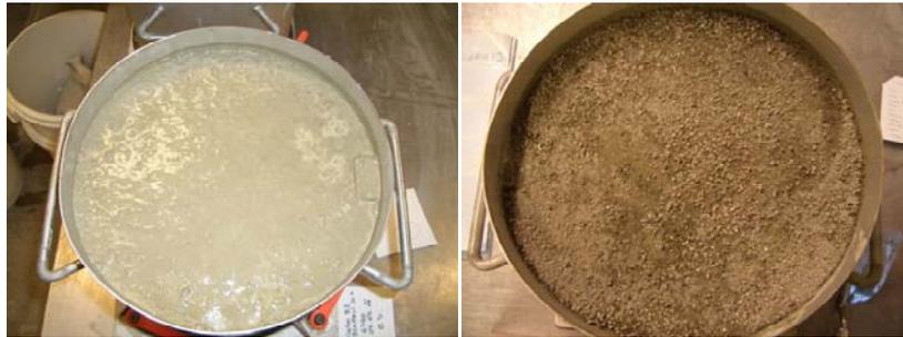
Abb. 6: Wasseraufnahme/Aufsaugverhalten der HKE im Bluttopf vor und nach der Einstreuung
