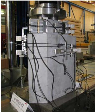
**Abbildung 3** Versuchsaufbau einer Gruppenverankerung von Spannritzten
