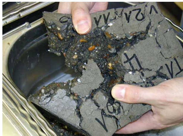
Bild: Silikatstaubhaltiger Probekörper mit (w/z)_{eq} = 0,35 nach 28 Frost-Tau-Wechseln
