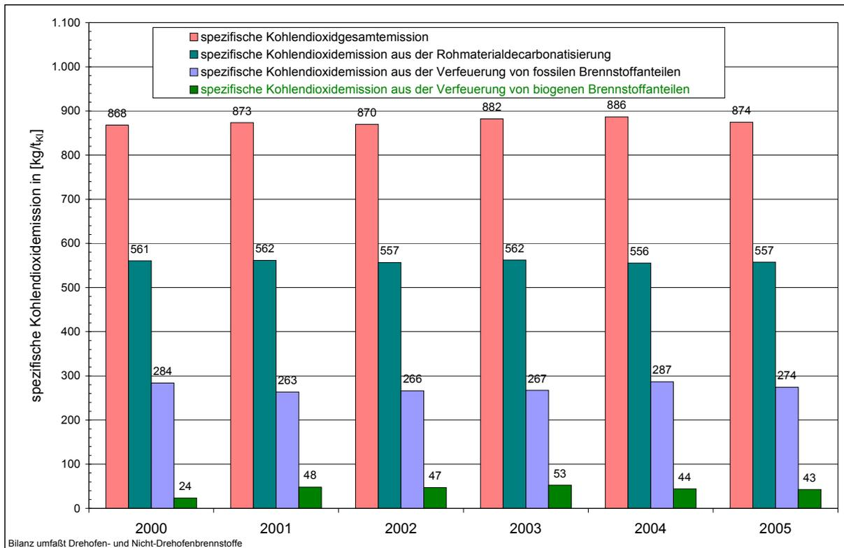
Abbildung 5-3: auf die Tonne Klinker bezogene, spezifische CO<sub>2</sub>-Emissionen (mit biogenen CO<sub>2</sub>-Emissionen) aus Anlagen der österreichischen Zementindustrie im Beobachtungszeitraum 2000 bis 2005
