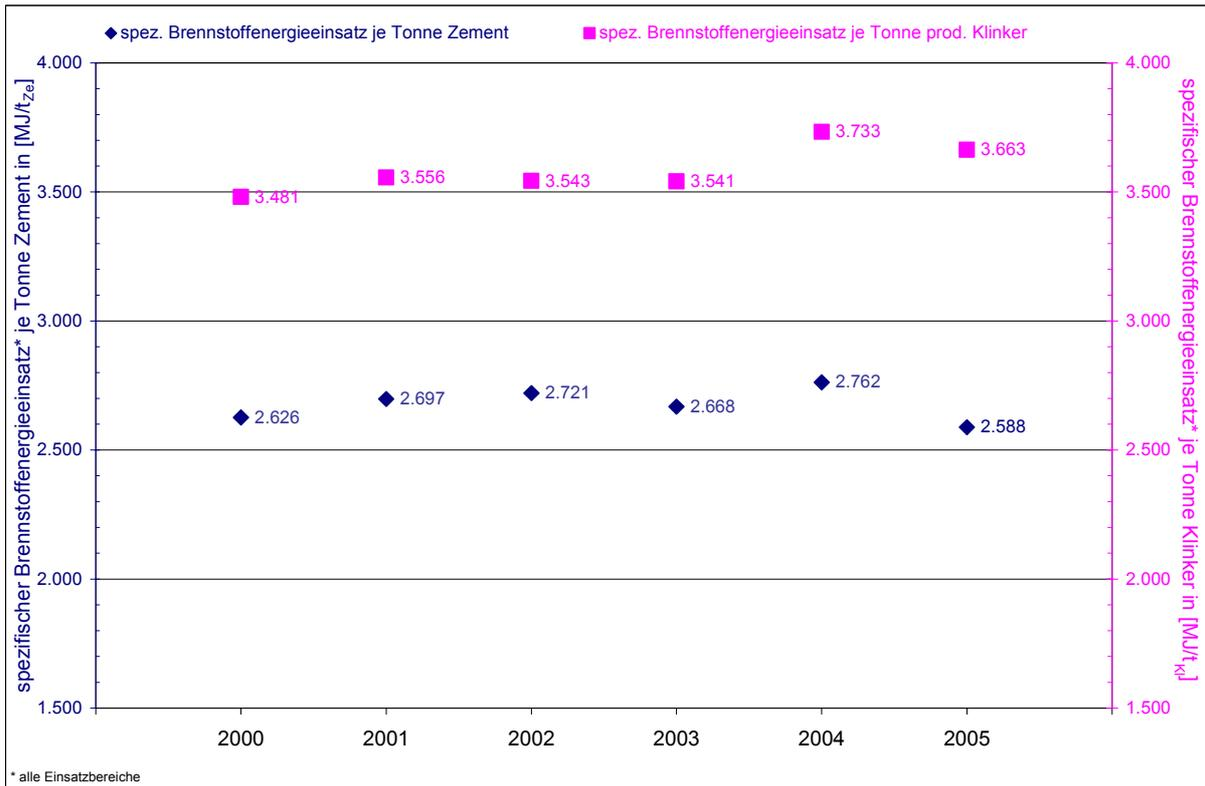
Abbildung 4-9: auf die Tonne Zement bzw. auf die Tonne Klinker bezogener spezifischer Brennstoffenergieeinsatz in Anlagen der österreichischen Zementindustrie für den Beobachtungszeitraum 2000 bis 2005
