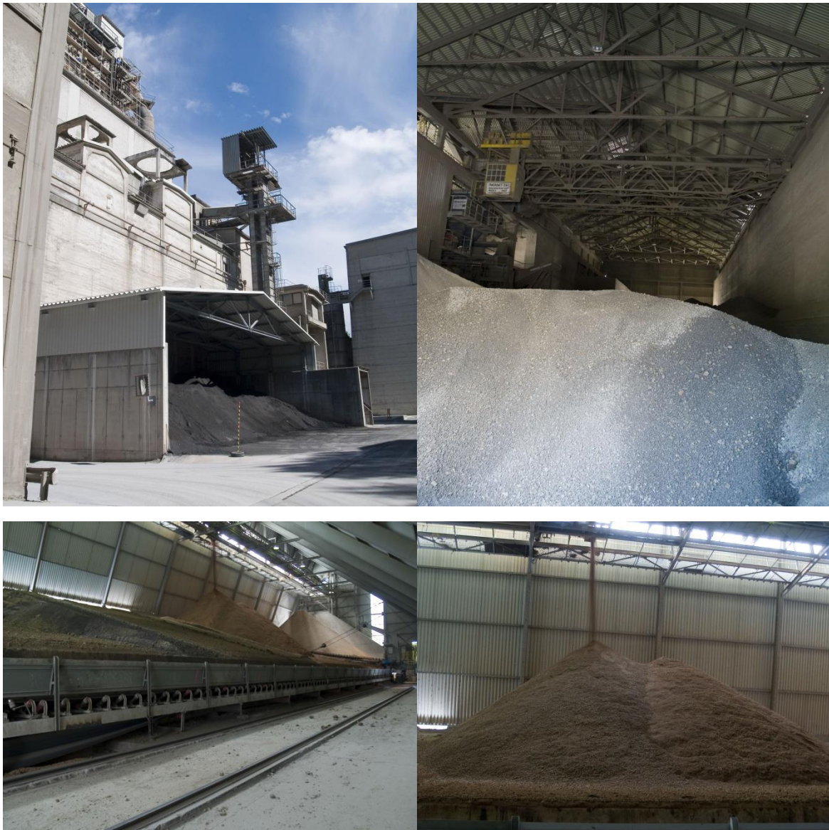
Bild 8-2 Beispiele für die Lagerung alternativer Rohmaterialien im Zementwerk (Quelle: VÖZ)
