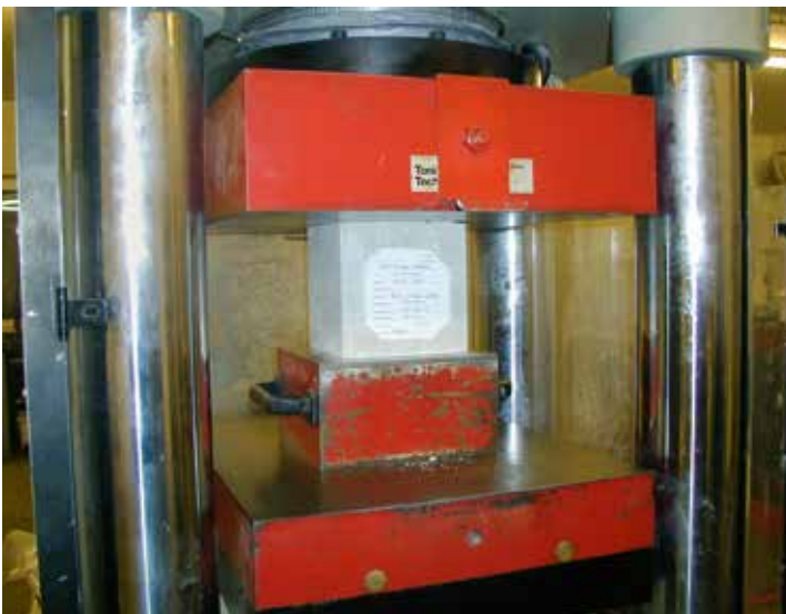
Bild 2: Druckfestigkeit von Beton
