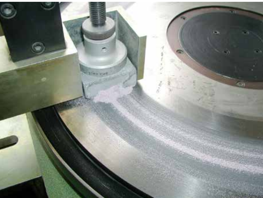
Bild 4: XM1 Prüfung mechanischer Abrieb nach Böhme
