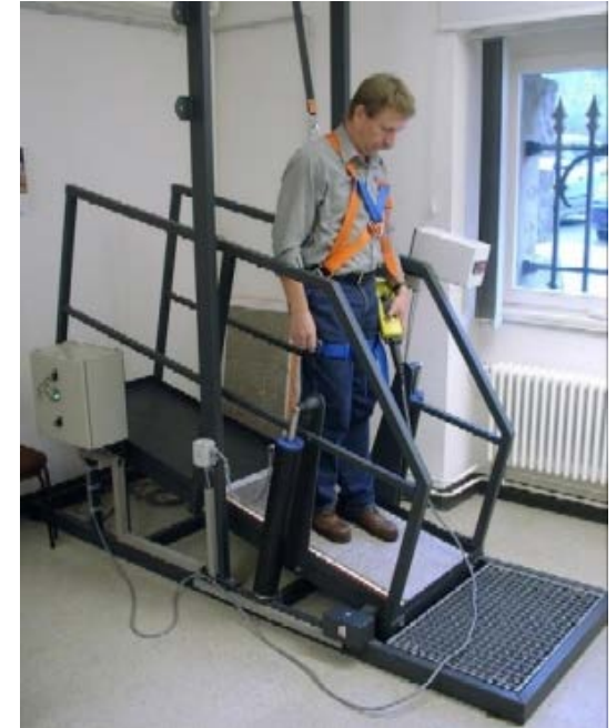
Begehungsverfahren DIN 51130 / BGR 181
