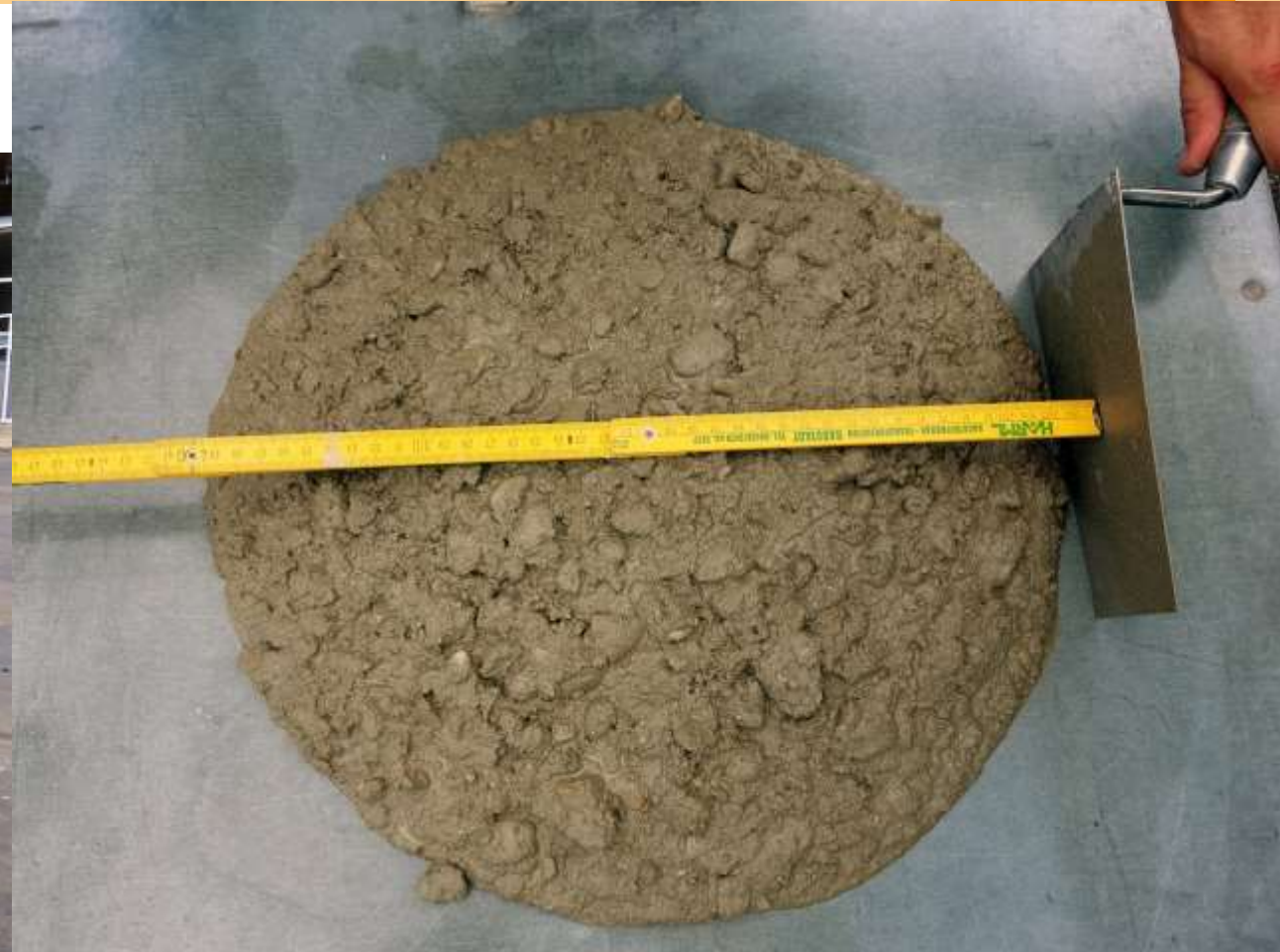
Beton vor Fließmittelzugabe
