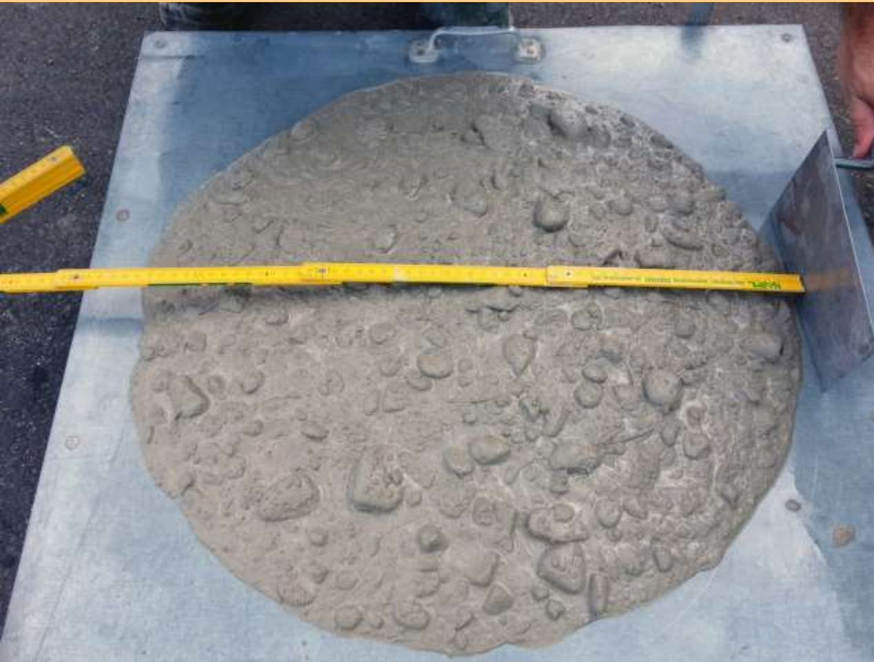
Beton nach Fließmittel- und Faserzugabe
